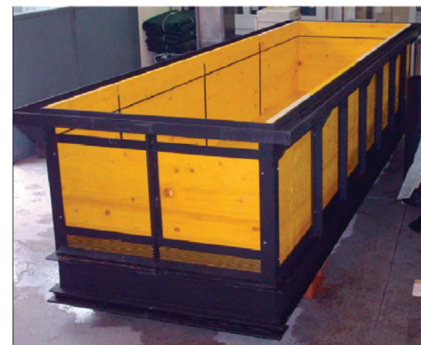
Fig. 10 - Particolare del cassone contenente la parcella sperimentale
